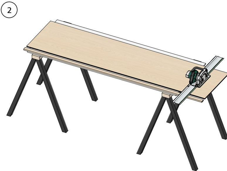
2. Höhe der vorhandenen Wände messen. Wandpaneel und Abschlussleiste mit einer Kreis- oder Tauchsäge auf die richtige Höhe zurechtsägen
